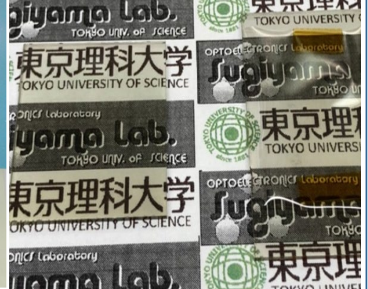
IoT向け透明太陽電池・センサ (ガラス&フレキシブル基板使用)
