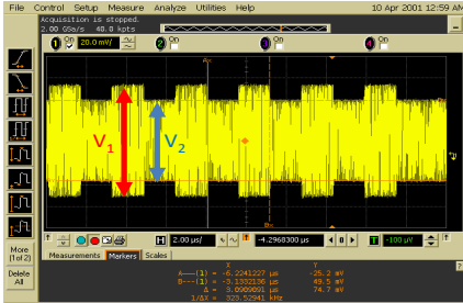
図 3-4 オシロスコープで観測される IC 送信信号
