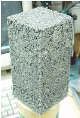
締固めてモールドから取り出した供試体
