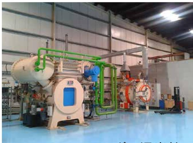
CNCガス浸炭炉
