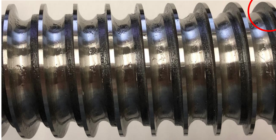
今回試作した非対称溝ボールねじ
