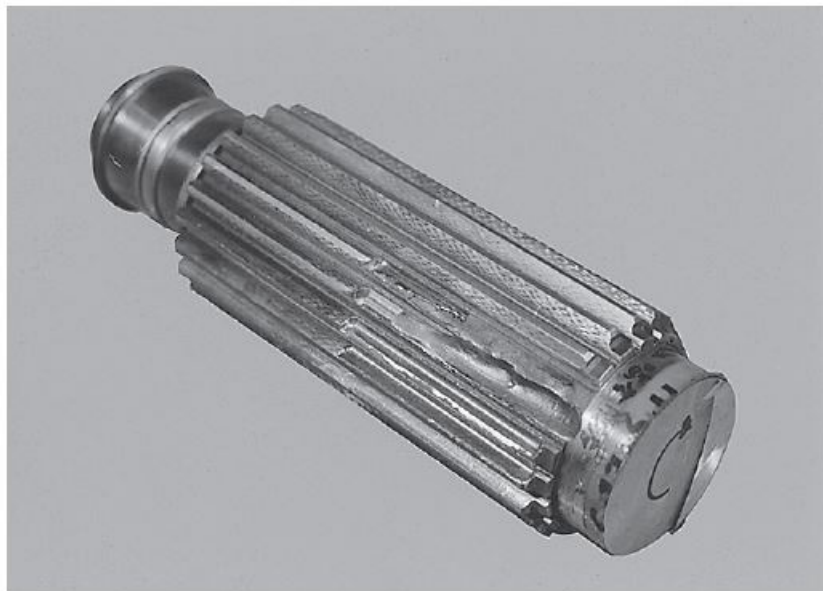
疲労破壊したスプライン軸
