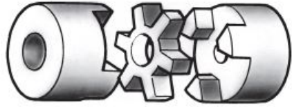
星形ゴム軸継手 (圧縮形)
