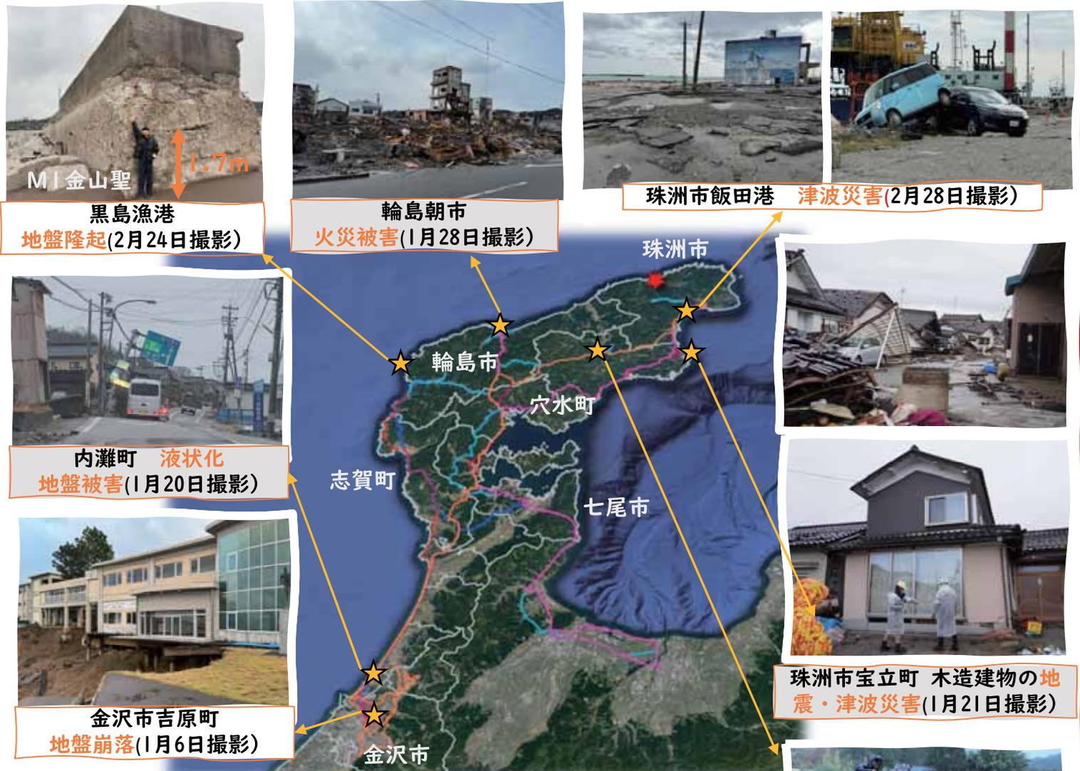
図1 現地調査による地震被害の抜粋
