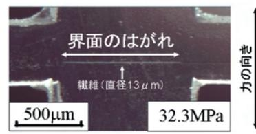
図1 光学顕微鏡で観察した界面のはがれ
