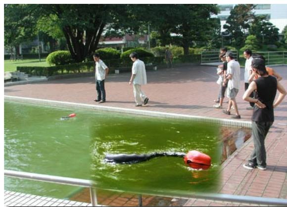
ンピュータとの階層制御を行うことによりロボットの運動に利用する試みを行っています。ここで紹介するロボットは尾部ほど波動の振幅が増大する機能を埋め込んだウナギ型ロボットです。多くの関節とそれらを制御するマイクロコンピュータを内蔵して泳ぎます。
