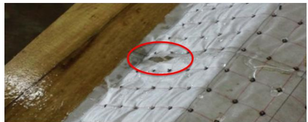
a) 1 波目 (水位差 20cm) 越流後 (陸側上方からの撮影)
