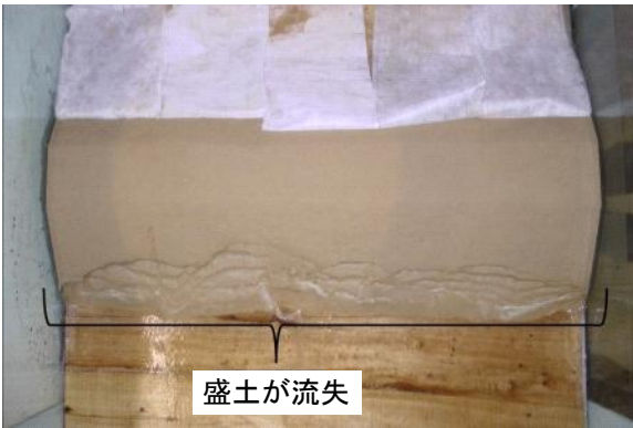
a) 1 波目 (水位差 20cm) 越流後 (真上からの撮影)
