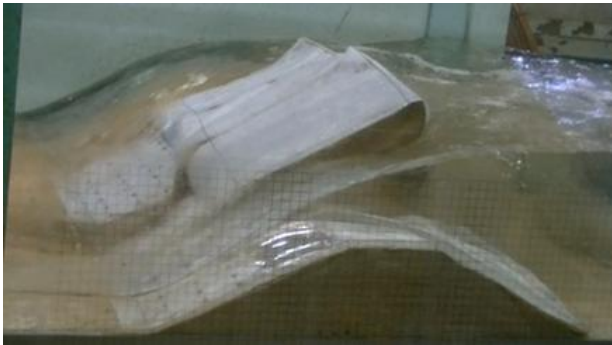
図-8 CASE02 1波目 (水位差 20cm) 2秒後 (陸側上方からの撮影)
