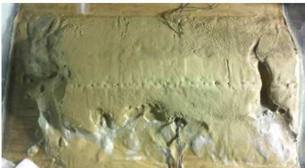
図-9 CASE04 3波目 (水位差 20 cm) 越流後、不織布を取り除いた盛土の状態
