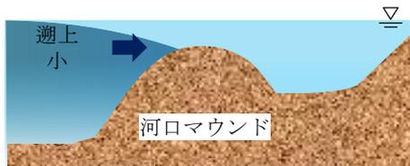
図-11 河口マウンドが有る場合の海水遡上阻害の模式図 (上げ潮時)
