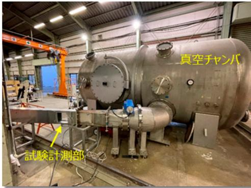
図1 吸い込み式超音速風洞
